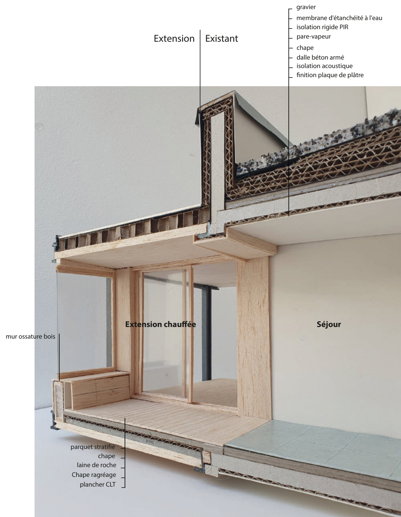
Figures 165 et 166: Maquette détail 1/20, raccord de l'existant avec l'ajout en extérieur Photographie: Auteure
