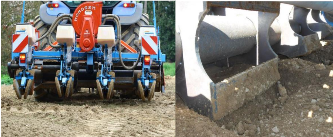
Figure 17 : A gauche, le combiné EruiStop, composé d'un semoir de précision, d'une rotative et d'un rouleau antiérosif. A droite, le rouleau anti-érosif créant les dépressions. (CIPF, 2023)
