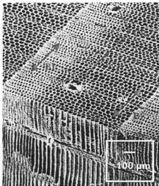
Figure 2 : micrographie d'un cerne annuel : BI correspond au bois initial, BF au bois final et CR aux canaux résinifères (photographie réalisée au microscope à balayage sur échantillon de Pinus resinosa) [Core H.A. et al., 1979].
