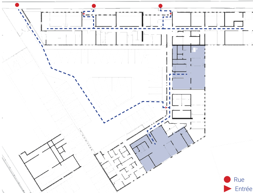
Fig. 39 Cheminement d'entrée de la MECS d'Aulnoye-Aymeries © Edgar Patin
