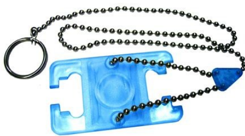
Figure 17 – Relascope à chaînette utilisé pour mesurer la surface terrière.
