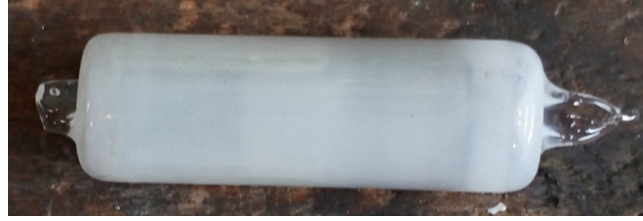
FIGURE 42 : Image de la capsule contenant l'alliage Fe-12Mn-18Zn, mis en oeuvre par métallurgie des poudres, après le traitement thermique à 800°C durant 2 jours. Un dépôt blanchâtre s'est formé à l'intérieur de la capsule.
