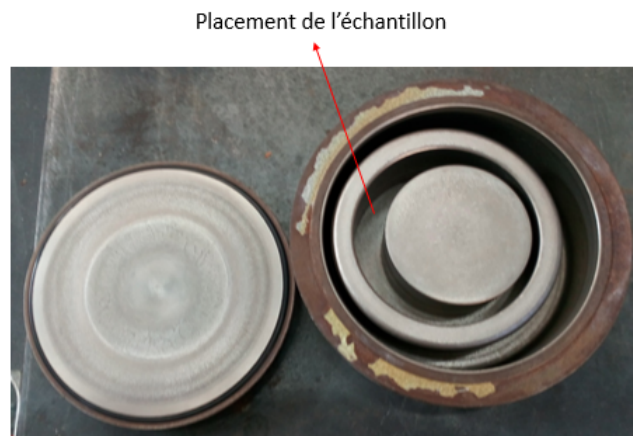
FIGURE 41 : Broyeur à anneaux utilisé pour réduire le manganèse électrolytique décapé en poudre.
