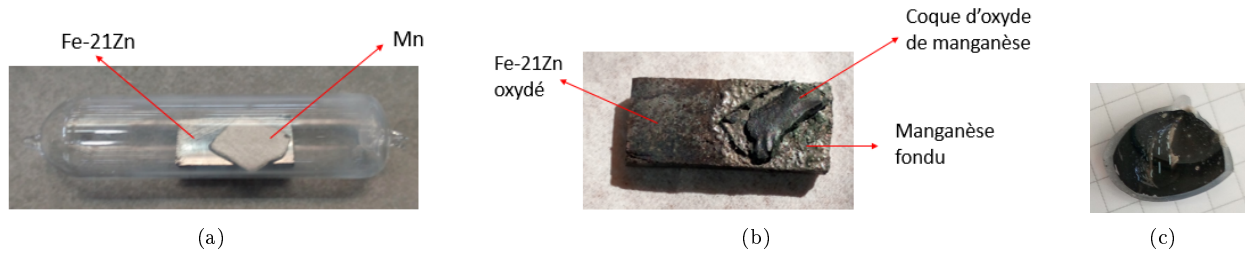
FIGURE 39 : Deuxième voie de mise en oeuvre des alliages Fe-Mn-Zn : traitement thermique d'un pré-alliage Fe-21Zn avec du Mn à 1255°C durant 20 min. (a) Placement des matériaux dans la capsule avant le traitement thermique (b) Résultat du traitement thermique après une trempe à l'eau (c) Manganèse déposé à la surface de la capsule après le traitement thermique.
