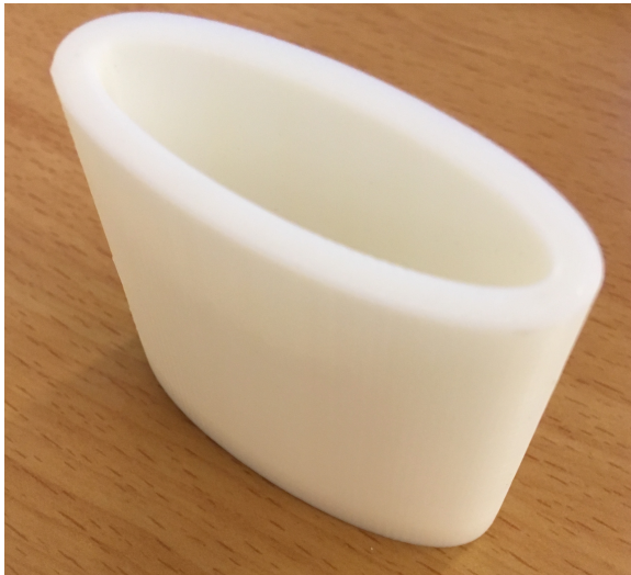
FIGURE 3.2 – Gobelet de test en ABS pour vérifier l'étanchéité.
