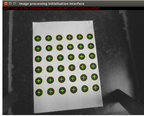
FIGURE 5.3 – Exemple de calibration faite avec le package visp_camera_calibration [3].
