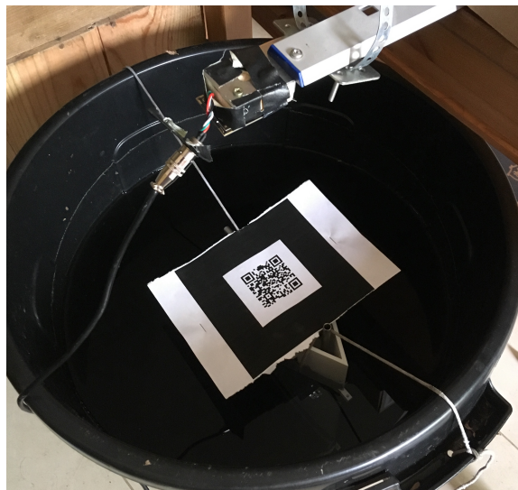
FIGURE 4.1 – Setup expérimental pour identifier le système en roulis.
