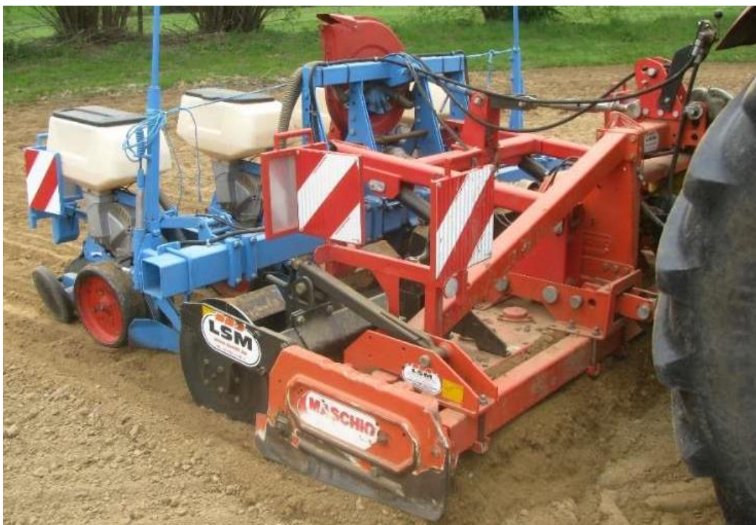
Figure 12: Combiné de semis ERuiStop du CIPF. De gauche à droite : semoir, rouleau antiérosif, rotative (source : CIPF).
