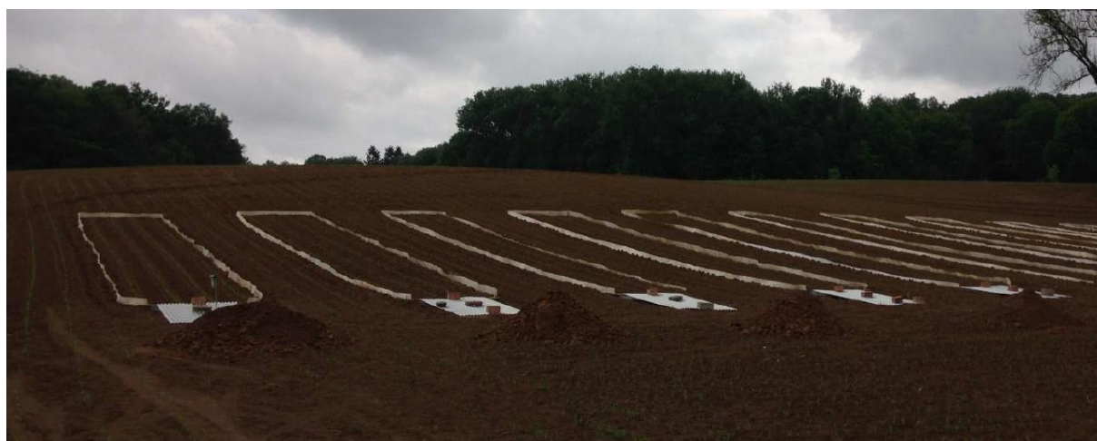
Figure 15: Disposition des parcelles d'essais sur la parcelle expérimentale et dispositif de mesure (site d'Ottignies). On peut observer les bandes de plastique rigide délimitant les parcelles ainsi que les bacs de récolte (ici recouverts par une tôle) (source : CIPF).
