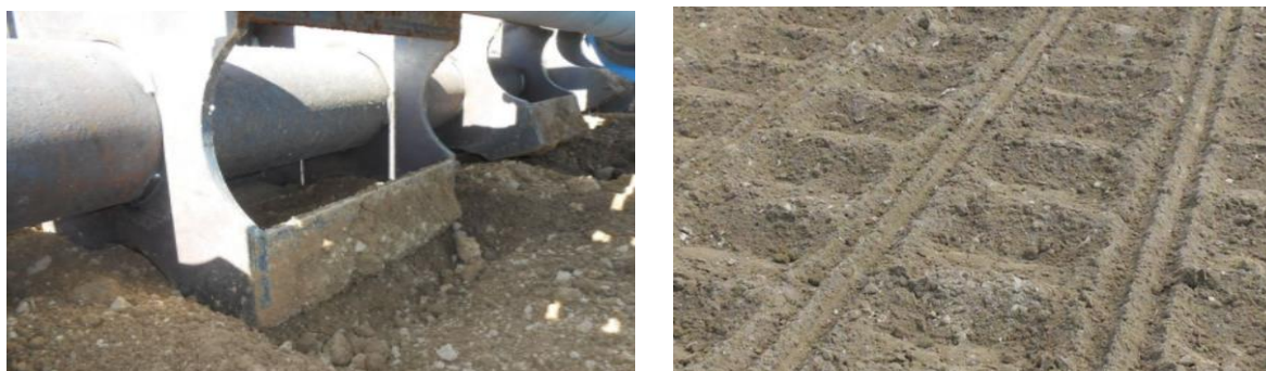
Figure 11: A gauche : vue détaillée des barres constituant le rouleau antiérosif. A droite : vue détaillée des dépressions créées dans les interlignes (source : CIPF).
