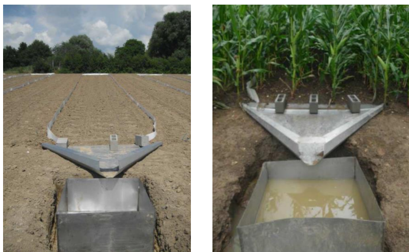
Figure 14: Dispositif expérimental de récolte d'eaux de ruissellement et de sédiments (source : CIPF).
