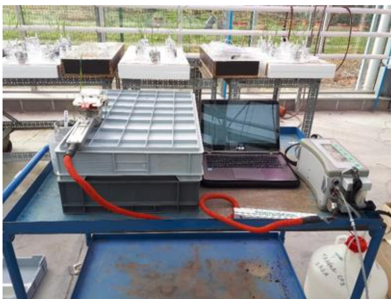
Figure 20 – Photo représentant la mesure en serres réalisée avec l'IRGA. Cet appareil a permis de mesurer la transpiration (E), la conductance stomatique ( g_s ) et le flux d'assimilation de CO_2 (A) des plantes de blé.
