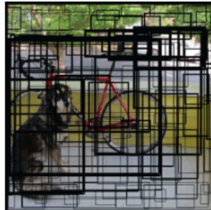
(b) Pour chaque cellule, l'algorithme prédit plusieurs bounding boxes. Au plus YOLO est certain que celles-ci entourent un objet, au plus elles sont épaisses.
