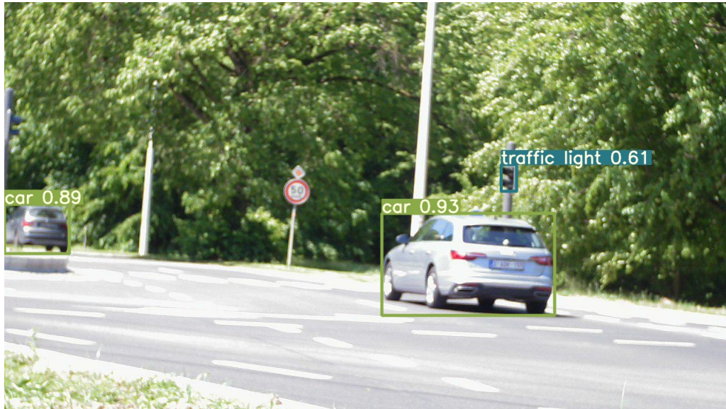
FIGURE 5.8 – Exemple de véhicules capturés par le système radar-caméra. On ne s'intéresse qu'au véhicule le plus proche du système bimodal.
