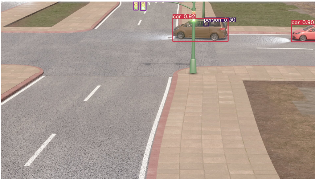
FIGURE 3.5 – Cette Figure illustre la détection d'objets réalisée par l'algorithme YOLO avec un seuil de 0.25. On constate qu'il est capable de détecter correctement des voitures mais également d'autres objets comme des personnes et des feux de signalisation. Nous pouvons constater que, malgré le fait que nous n'ayons pas entraîné le modèle, celui-ci fournit tout de même les résultats escomptés. Par ailleurs, on constate également que le feu de signalisation situé sur la partie verticale du poteau n'est pas détecté, ce qui résulte de la valeur du seuil choisi.
