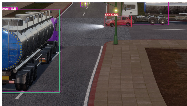
FIGURE 3.6 – Sur cette Figure, on y voit deux camions et une voiture. Nous pouvons constater que le camion le plus proche de la caméra (celui de gauche) est à la fois détecté en tant que camion mais également en tant que train. Il en résulte qu’il y a deux détections pour une seule cible.
