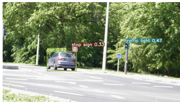
FIGURE 5.5 – On constate que l’algorithme YOLO, bien qu’il ne soit pas entraîné, capture correctement les véhicules.
