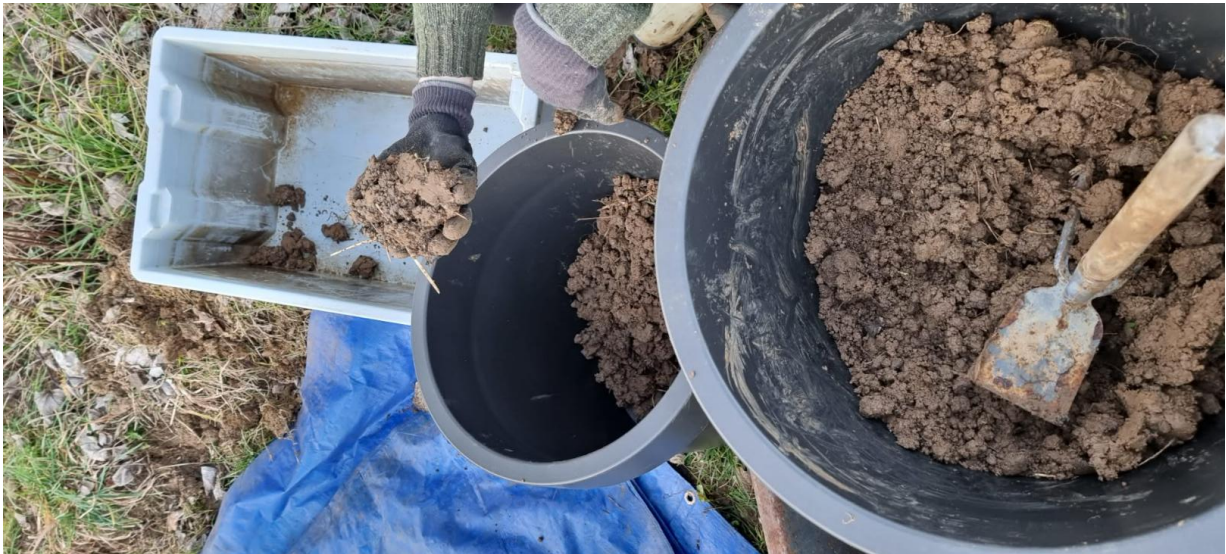
Figure 18: Tri manuel de la macrofaune pour le remplissage des pots expérimentaux
