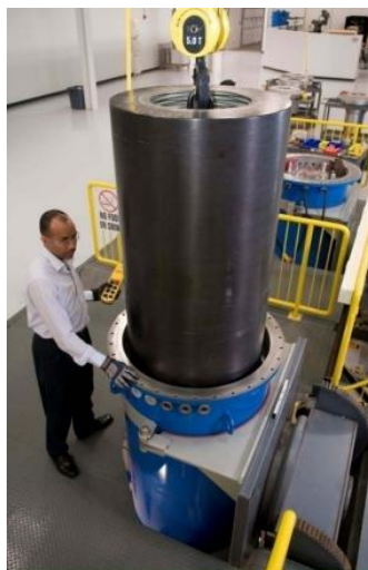
Figure 3-1 : FESS à réponse rapide pour la régulation de fréquence du réseau
