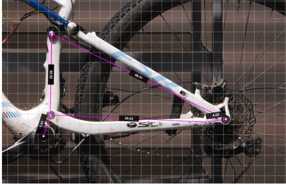
FIGURE 3.8 – Dimension du triangle de suspension arrière, coté gauche.
