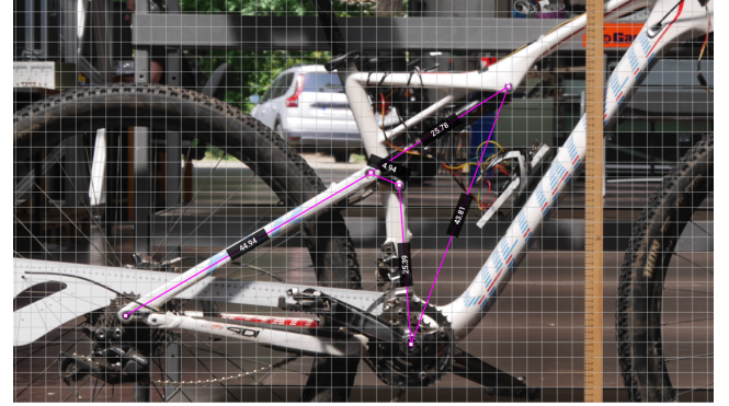
FIGURE 3.9 – Dimension du triangle de suspension arrière, coté droit.
