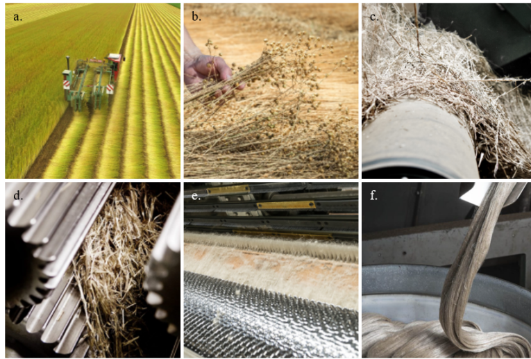
FIGURE 2.1 – Illustration des différentes étapes de traitement des fibres de lin : a. Arrachage, b. Rouissage, c. et d. Teillage, e. et f. Peignage (image retravaillée) [19] [20]
