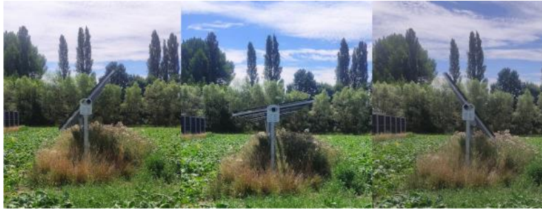
Figure 5 : Système de suivi solaire mono-axe est-ouest dans différentes positions. (source : Brecht Willockx et al., 2024).
