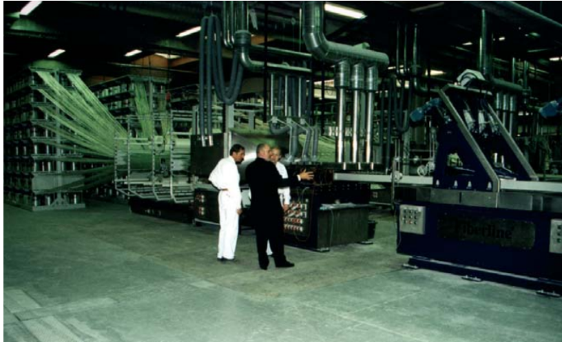
FIGURE 1.4 – Equipements de la chaîne de pultrusion de Fiberline[3]
