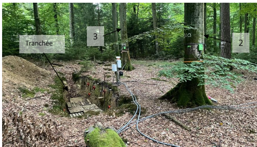
Figure 16 : Photo du site d'étude Vielsalm avec la tranchée et les arbres 2 et 3 de l'étude. Les capteurs Teros 21 ont été installés dans les tubes oranges visibles dans la tranchée, à 2 profondeurs différentes : 30 et 75 cm..
