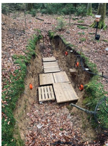
Figure 18 : Photo de l'installation des capteurs Teros 21 (voir figure en haut à droite) sur le site de Lauzelle (en haut) et de Vielsalm (en bas) en avril 2025.
