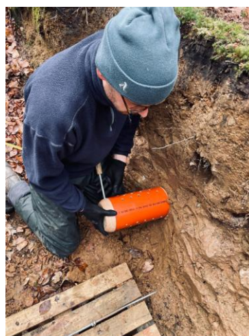
Figure 18 : Photo de l'installation des capteurs Teros 21 (voir figure en haut à droite) sur le site de Lauzelle (en haut) et de Vielsalm (en bas) en avril 2025.
