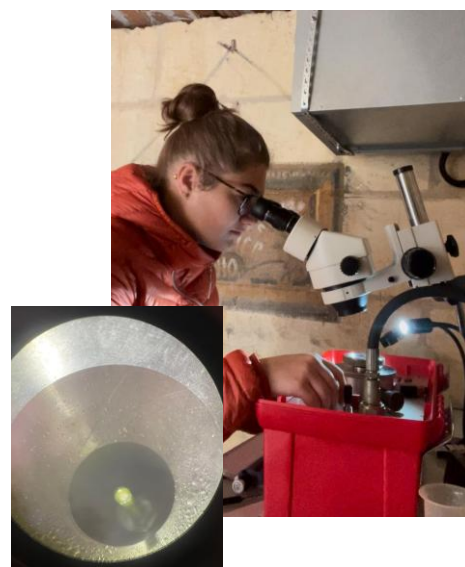
Figure 19 :Photo de l'utilisation de la chambre à pression (Scholander) pour mesurer le potentiel hydrique foliaire à mi-journée.
