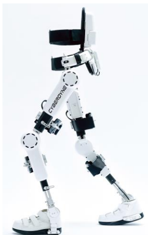
Figure 15 Exosquelette HAL développé par la société Cyberdyne
