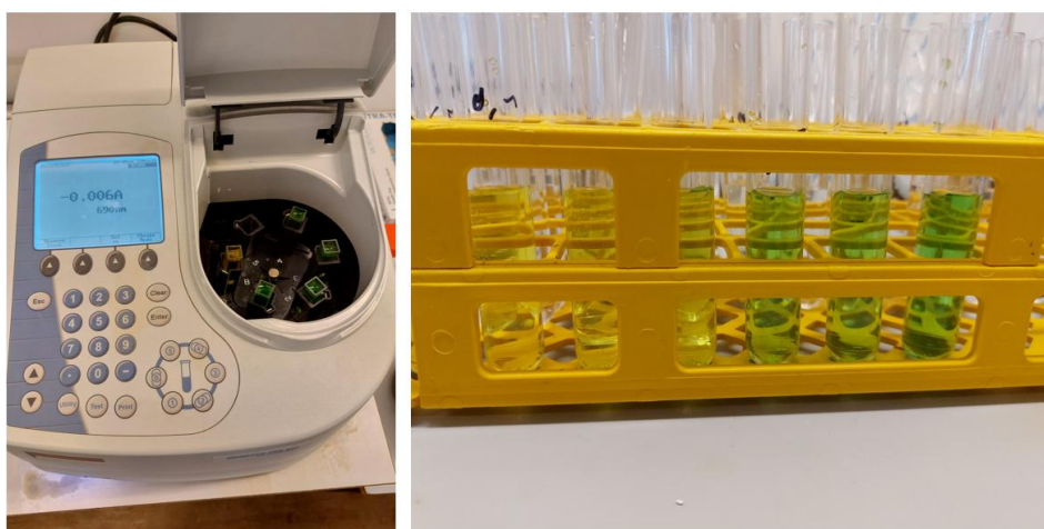
Figure 21 - Photos du spectrophotomètre (à gauche) et des solutions standards (à droite)
