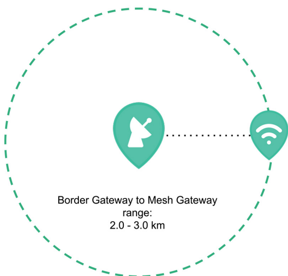
FIGURE 1.5 – Portée de communication entre une passerelle maillée Silvanet Mesh Gateway et une passerelle frontière Silvanet Border Gateway.
