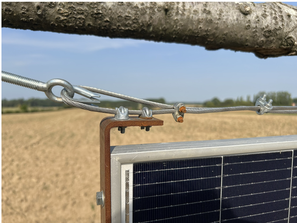
FIGURE IV.7 – Assemblage à câbles installé sur prototype.
