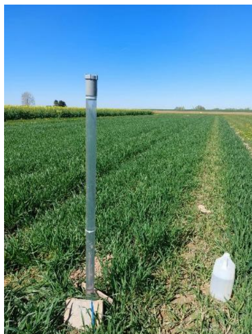
Figure 7 : Photo du dispositif expérimental d'une mesure Porchet
