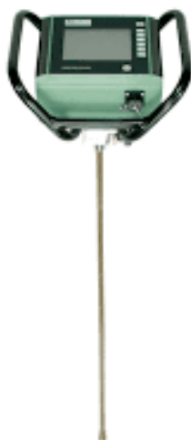
Figure 10 : Photo illustrant le pénétromètre utilisé pour les mesures (SDEC France, 2026)
