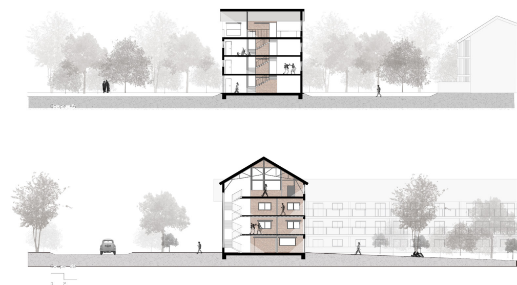
Figure 86 : Coupe du bâtiment pour les associations
