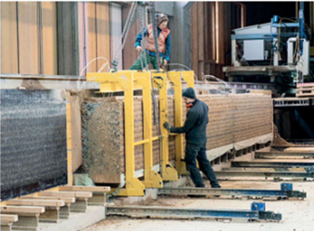
Figure 46 : Photographie de la réalisation des blocs pisé préfabriqués
