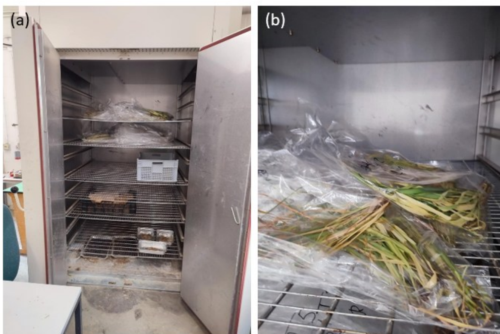
Figure 4-9 : (a) Parties aériennes et racinaires des plantes disposées sur les deux étages supérieurs de l'étuve (salle H04840). (b) Séchage des parties aériennes dans des sachets microperforés dans l'étuve à 65 °C.
