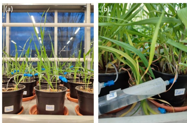
Figure 4-8 : (a) Positionnement des rhizons dans les pots pour l'extraction de solution du sol. (b) Illustration de la collecte de la solution de sol à l'aide d'une seringue raccordée au rhizon.
