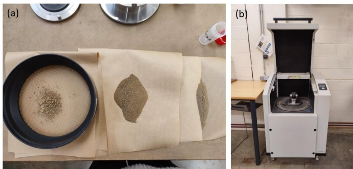
Figure 4-7 : (a) Aspect du sol avant tamisage (gauche), après tamisage (centre) et après broyage (droite). (b) Broyeur utilisé pour la préparation des échantillons de sol.
