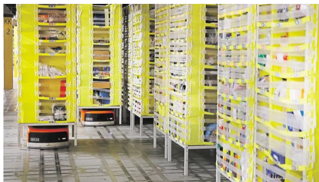
Figure 4 - Le robot Kiva transportant une étagère
