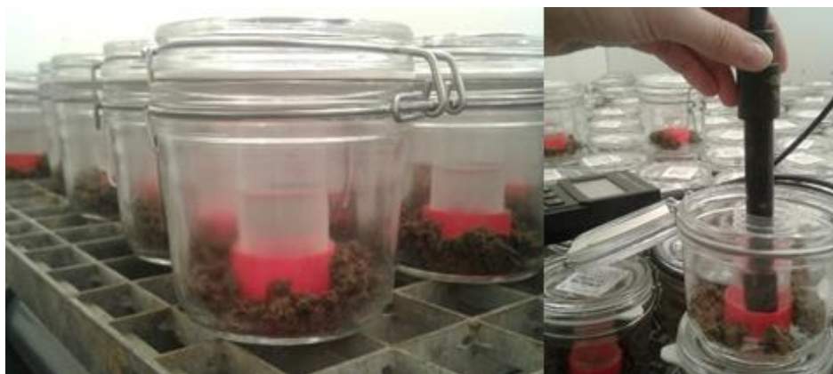
Figure 21 : A gauche : bocaux fermés hermétiquement et contenant du sol frais et une solution de NaOH. A droite : mesure de la conductivité de la solution de NaOH à l'aide du conductimètre.
