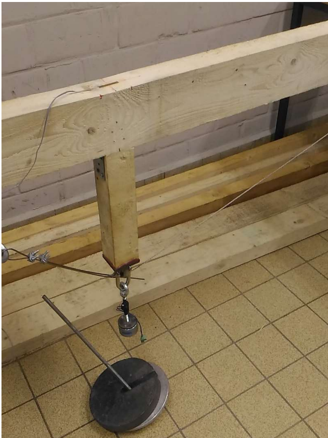
Figure 98 - Jauge de déformation et plateau de mise en charge
