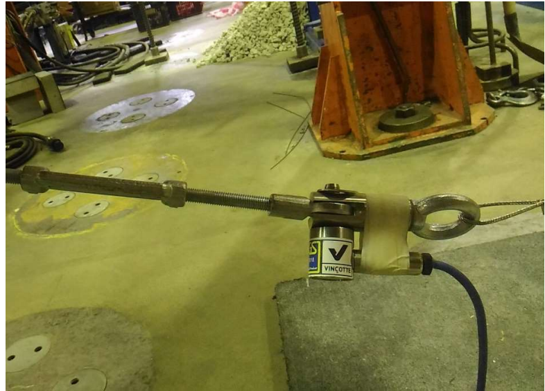
Figure 92 - Capteur de force en ligne avec le tendeur du câble
