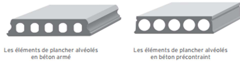
Figure 22 - Schéma de hourdis armé et précontraint [31]
