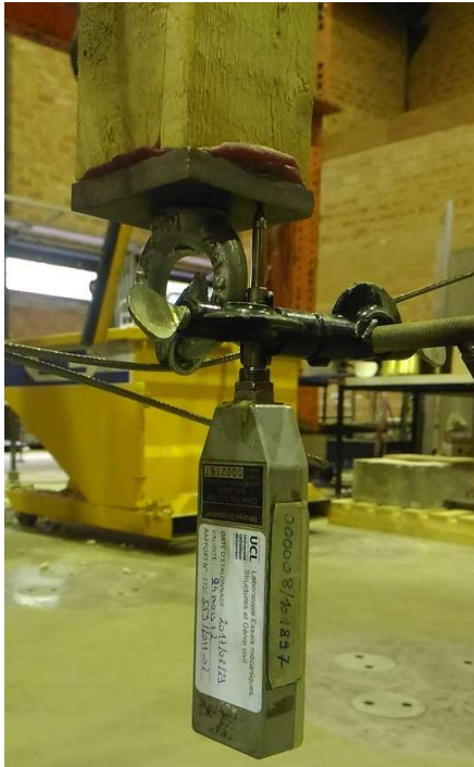
Figure 91 - LVDT pour mesurer la flèche globale
