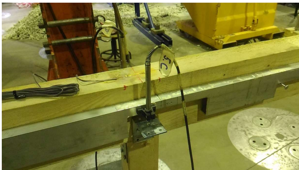
Figure 90 - LVDT pour mesurer la flèche locale
