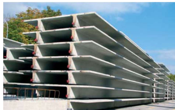
Figure 27 - Éléments TT : schéma et photo [31] [32]
