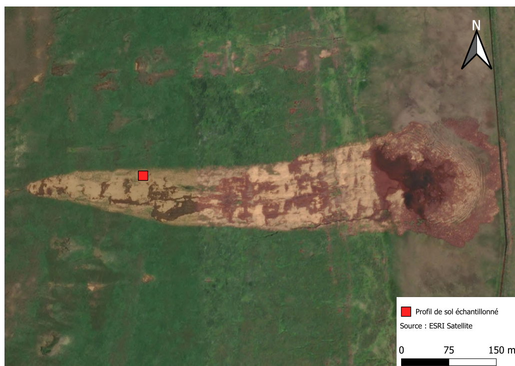
FIGURE 3.6 – Image satellite du glissement avec la position du profil de sol échantillonné, en bordure nord supérieure de la cicatrice. Fond satellite : Esri et al. (2024) (service World Imagery , EPSG :3857).
