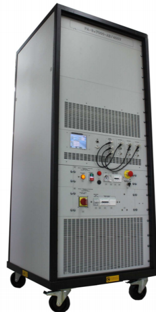
FIGURE 1.22 – Amplificateur de puissance 4 quadrants de 3X7000VA
