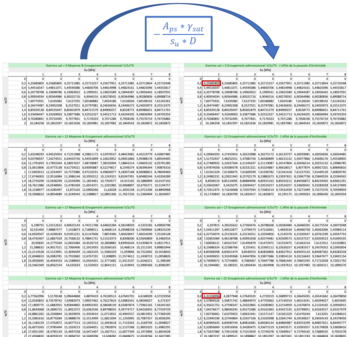
Figure 48 Résultats de la résistance à la pénétration obtenus en soustrayant la composante liée à la poussée d'Archimède
