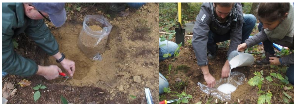
Figure 4: Prélèvement des sols minéraux et mesure du volume
