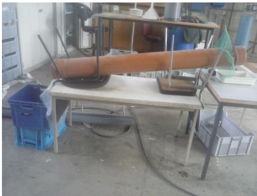
Figure 6: Dispositif pour séparer les cailloux des racines
