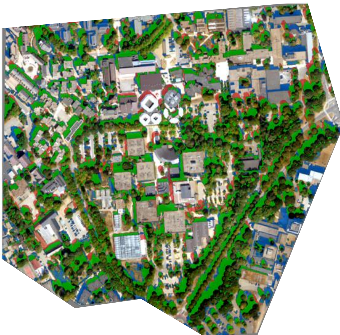
Figure 22 : Carte de concordance des ombres simulées (12h30) et observées sur orthophoto de 2022. 65 En rouge : les ombres simulées et non détectées. En vert : les ombres détectées et en accord avec la simulation. En bleu : les ombres détectées seulement sur l'orthophoto et non simulées.
