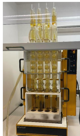
Figure 13 : Dispositif d'extraction sous reflux
