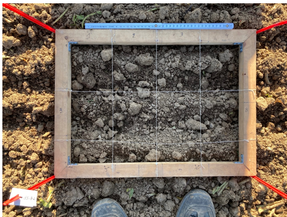
Figure 15 : Exemple d'installation d'une placette de battance (G. Dehaye)
