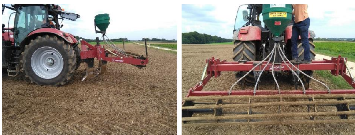
Figure 13: Décompacteur à 5 dents suivi du semoir dans la ligne décompactée (Soumoy, 2018).
