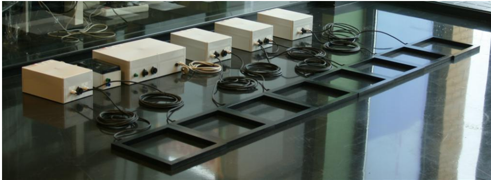
FIGURE 5.12 – Ensemble des cinq boîtiers composant le système d'acquisition des données RFID.
