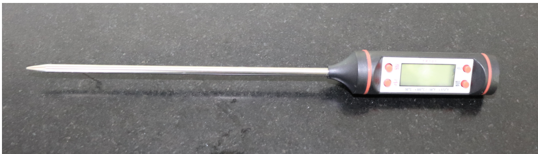
FIGURE 5.21 – Photo du thermomètre utilisé pour les mesures de températures d'eau du modèle simplifié de rampe et du vivier de stockage.
