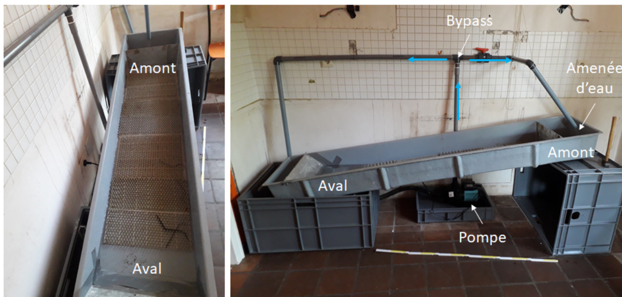
FIGURE 4.19 – Photos du modèle simplifié d’une rampe à anguilles.
