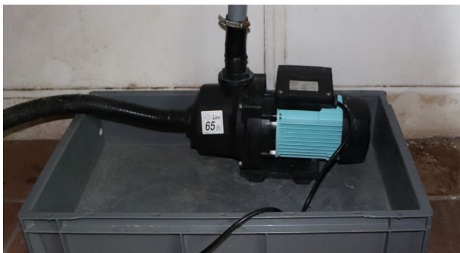
FIGURE 5.22 – Photo de la pompe utilisée dans le modèle simplifié de rampe à anguilles.
