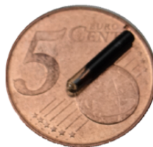
FIGURE 5.13 – Représentation physique de la taille d'un PIT-tag de 12 [mm] comparé à une pièce de monnaie (Courtois and Van Audenhaege, 2017).
