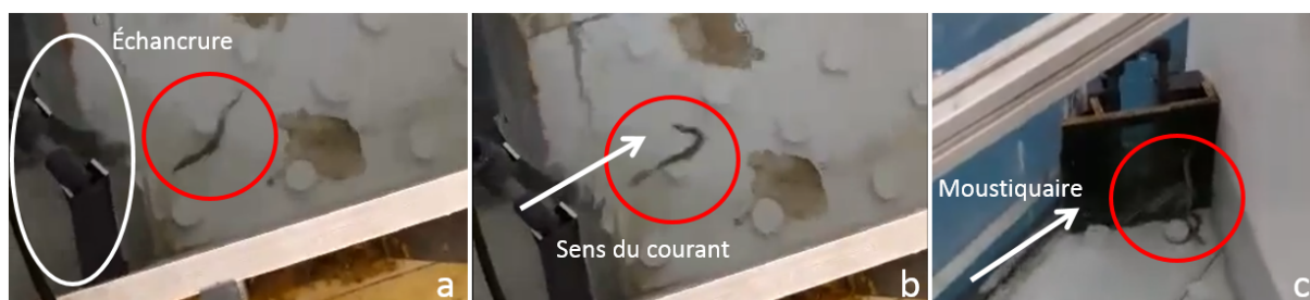
FIGURE 6.16 – Clichés des observations constatées lors des seconds tests préliminaires sur les anguilles. (a) anguille tentant de franchir l'échancrure (b) anguille expulsée par le courant (c) anguilles plaquées à l'aval.
