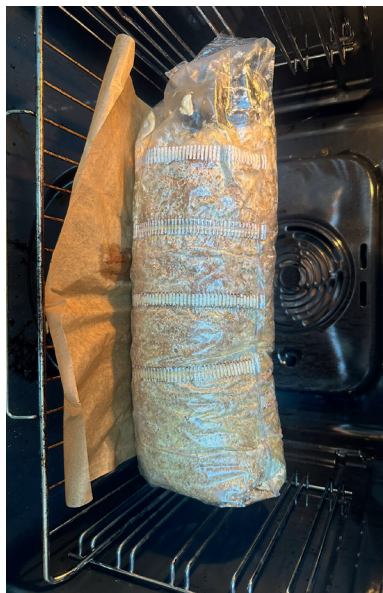
Fig 23. Traitement thermique à 60°C.
