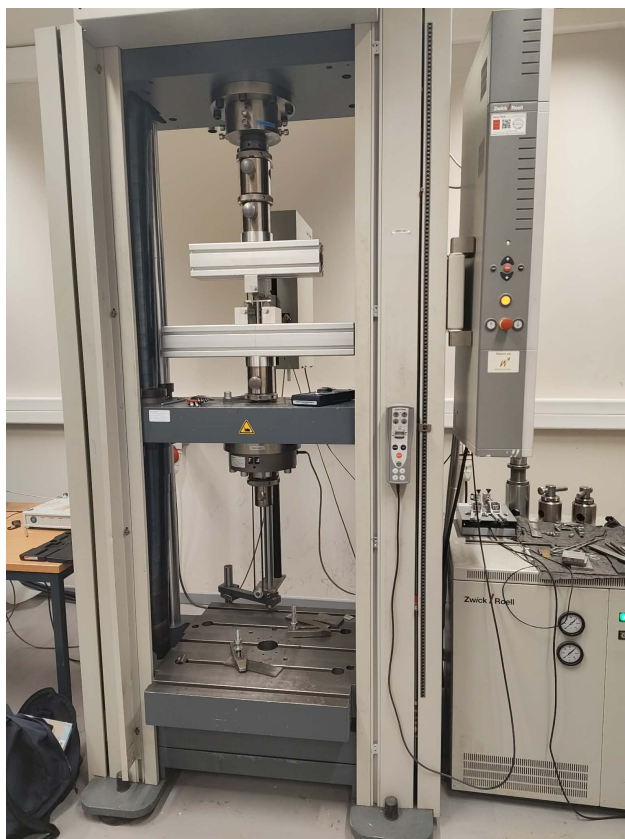
Figure 3.15: Machine universelle de traction-compression Zwick/Roell Z250 utilisée pour les essais de flexion du LEMSC , de l' EPL .
