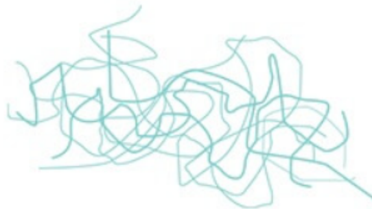
Figure 2.5: Illustration des chaînes macromoléculaires d'un thermoplastique amorphe. 3
