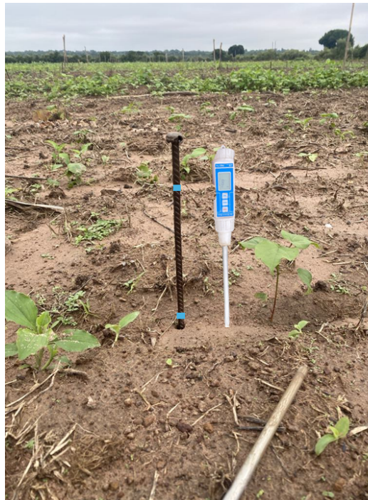
Figure 4.12 – Méthode de mesure de la teneur en eau volumique ( \text{cm}^3/\text{cm}^3 ) du sol avec l’humidimètre (PMS-714 de chez Lutron) (ELECTRONIC, 2024). La barre métallique permet d’enfoncer l’humidimètre aux profondeurs souhaitées des mesures (indiquées ici par des repères en bleu) : surface, 10 cm et 30 cm.
