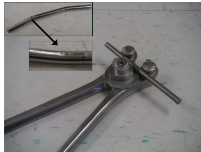
FIGURE 1.12 – Le french bender est un outil permettant de plier localement la tige de croissance. Cet outil laisse des marques sur la surface de la tige - [22]
