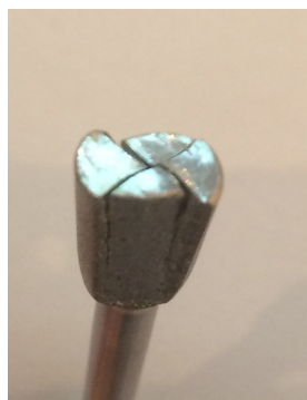
FIGURE 4.13 – Alliage de titane ayant cassé dans les mors
