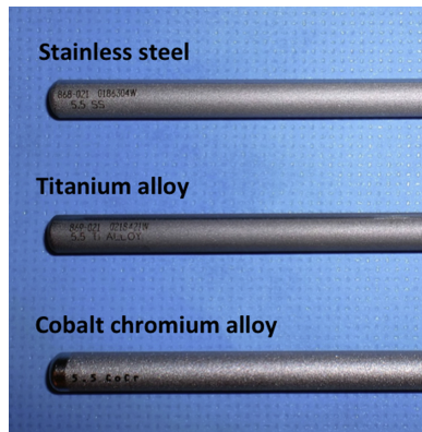
FIGURE 1.13 – 3 tiges de 5.5 mm de diamètre en acier inoxydable, alliage de titane et alliage de cobalt chrome - [2]
