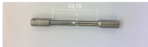
FIGURE 2.15 – Éprouvette utilisée lors des essais Bauschinger
