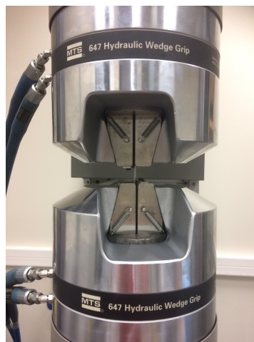
FIGURE 2.16 – Photo prise durant l'expérience de Bauschinger
