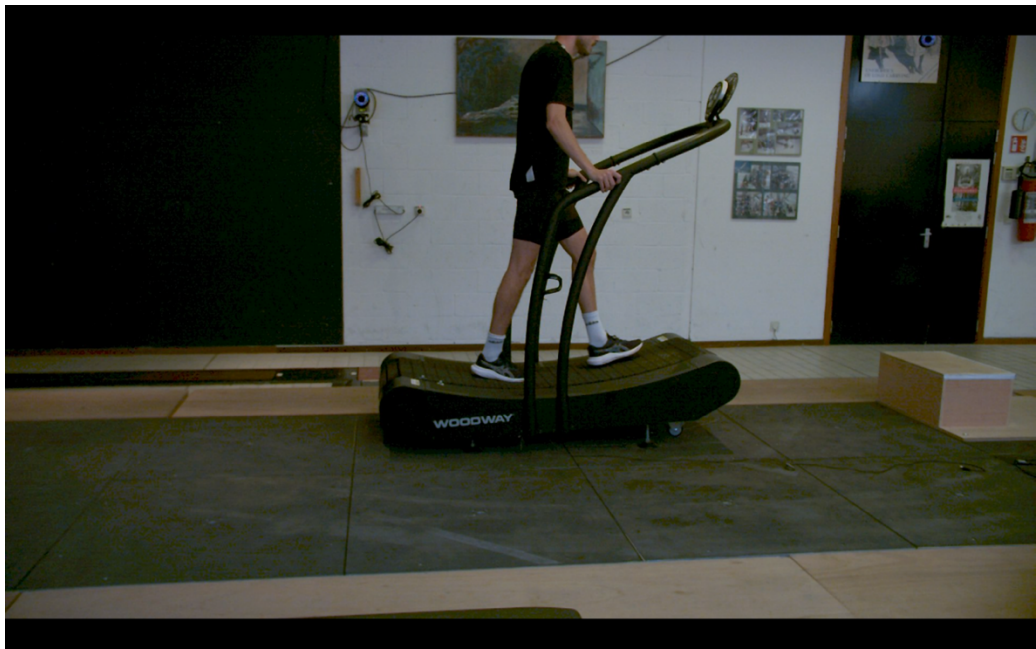
Fig. 5. Dispositif expérimental. Le tapis est posé sur 2 plateformes de force adjacentes et connectées.
