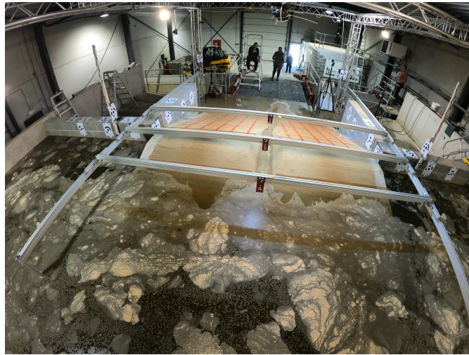
FIGURE 3.38 – Rails avec les sondes de niveau ajoutées lors de l'essai Qm3
