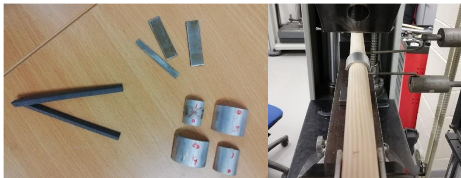
Figure 90: Appuis en aluminium pour les tests statiques (Gauche), éprouvette avant son chargement statique (Droite)
