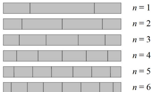
Figure 11 : Nœuds de la flexion selon le NPL (n étant le numéro de l'harmonique) (NPL, 2006)
