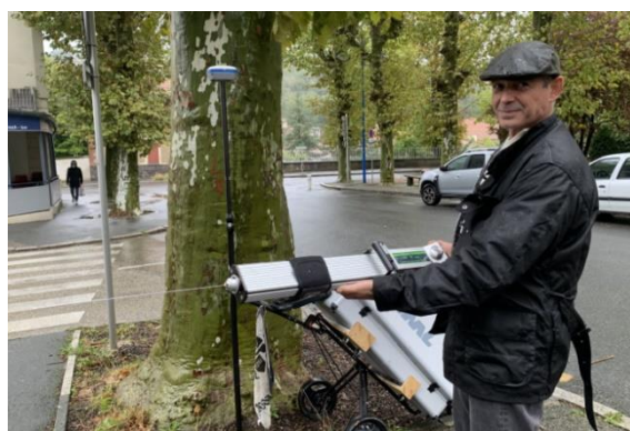
Figure 28: Résistographe (Photo d'archives Progrès /Yoann TERRASSE)
