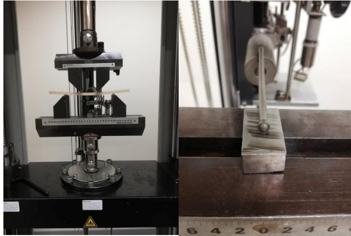
Figure 44 Photo de La machine Zwick® et de l'extensomètre à boule sa plaquette anti-glissement.
