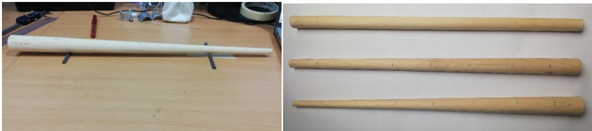
Figure 89: Cônes en configuration dynamique flexionnelle (Gauche), Différentes conicités : Cylindre, petite conicité, grande conicité (Droite)
