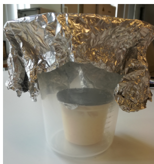
Figure II.2 – Dispositif mis en place pour incuber le riz au lait dans un environnement stérile.
