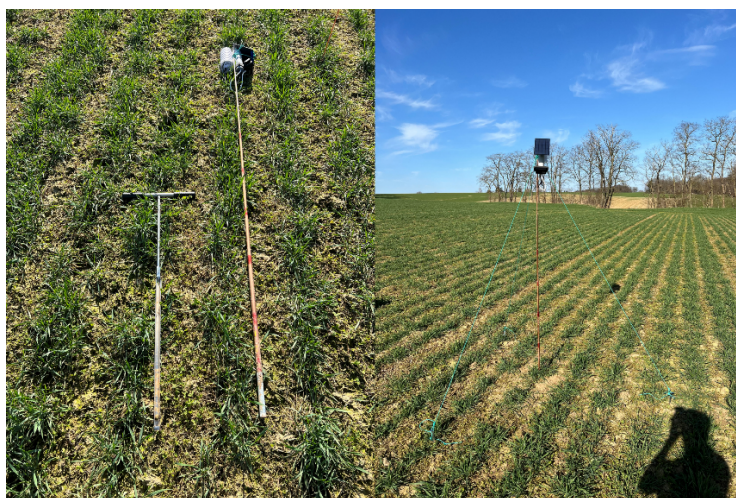
FIGURE 3.14 – Tarière gouge monobloc et piquet installé en champ
