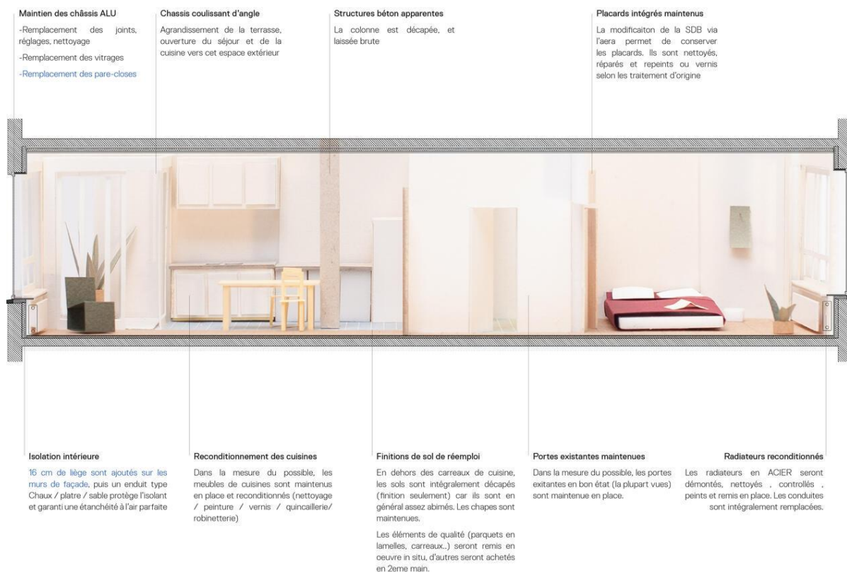
Fig. 51. Karbon', Interventions et matérialité , s.d., photo de maquette annotée, Karbon'
