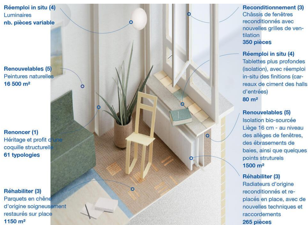
Fig. 49. Karbon', Interventions et matérialité , s.d., photo de maquette annotée, Karbon'
