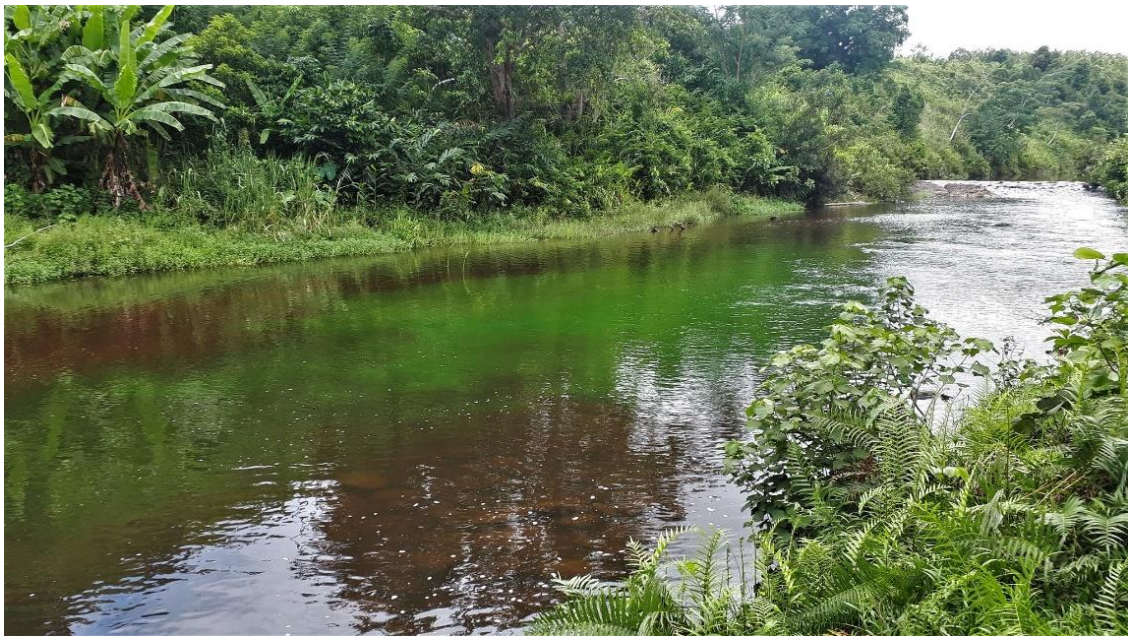
Figure 20 : Nuage de fluorescéine après injection dans la rivière Antsahovy en amont de la section de mesure
