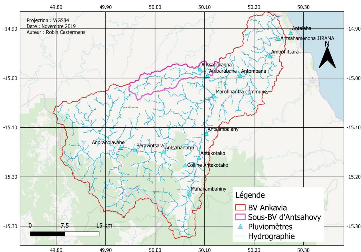
Figure 10 : hydrographie et réseau de pluviomètres du bassin versant d'Ankavia
