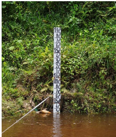
Figure 15 : Limnimètre installé au niveau de la section de référence.
