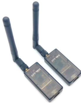
Figure 1.13 – Émetteur/Récepteur mro sik telemetry radio v2 433mhz.
