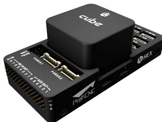
Figure 1.11 – Contrôleur de vol Pixhawk 2 , le Cube .
