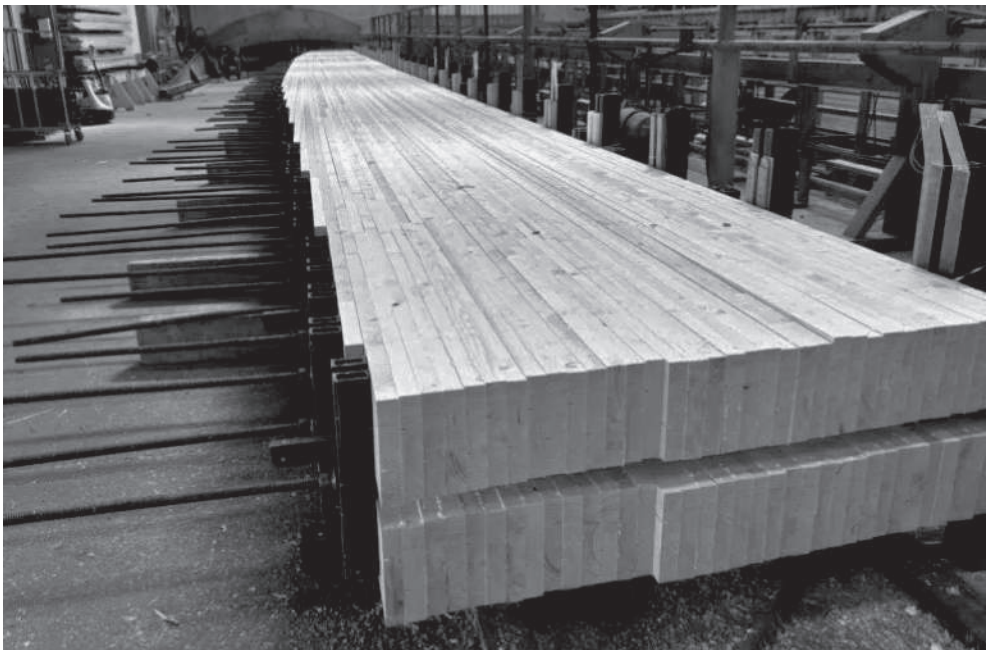
Fig. 117 : conception en usine du lamellé-collé
