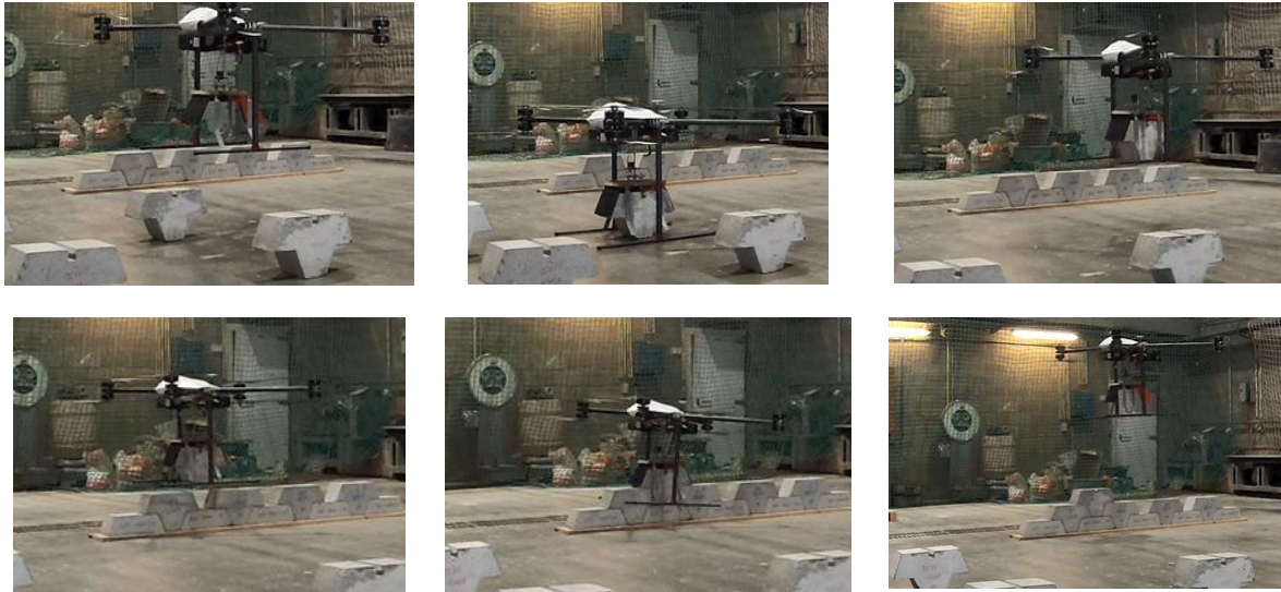
Figures 260 - Phase de préhension, transport et pose du DEPT d'essai
