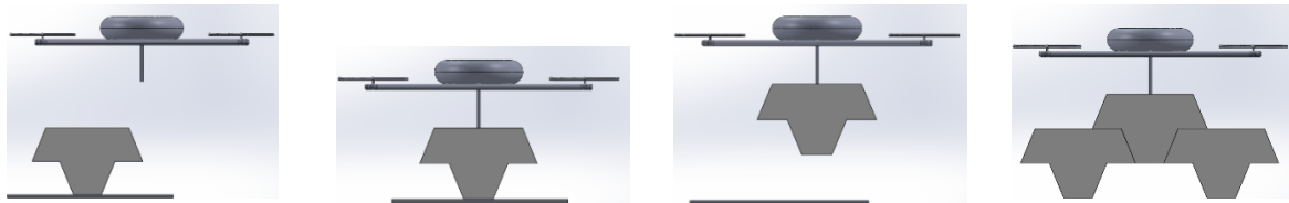
Figures 116 - Etapes de préhension, transport et pose de l'élément
