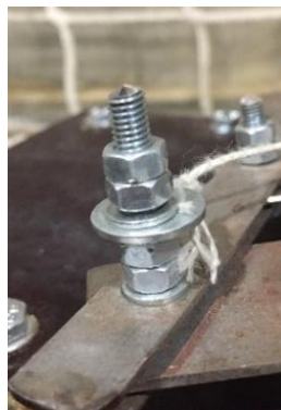
Figure 257 - Serrage par double-écrous
