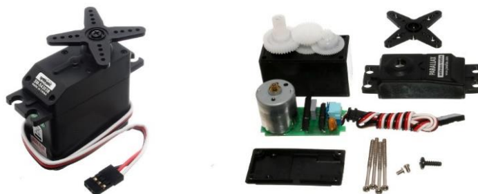
Figures 192 – Servomoteur utilisés dans les GGS et ses composants
