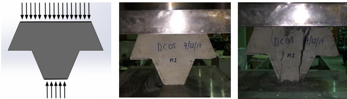
Figures 272 - Cas 5: Schéma du cas expérimenté, dispositif d'essai et DEPT avec fissuration avant rupture
