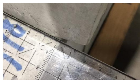
Figure 255 - Décalage latéral type entre 1er étage et 2ème étage
