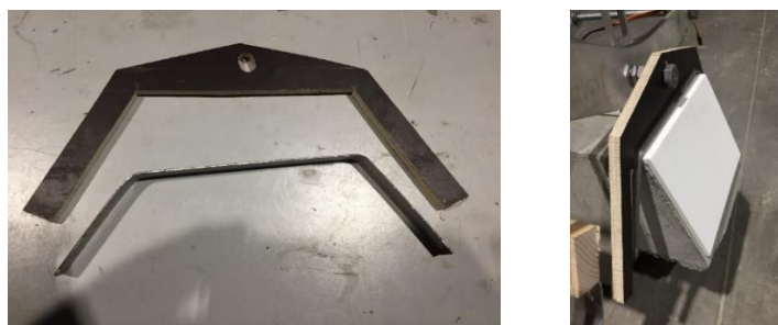
Figures 210 - Rails de guidage latéral en préhension du GGS-G
