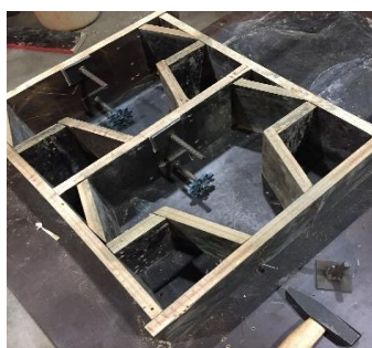
Figure 179 - Fixation des plaquettes d'acier au moule
