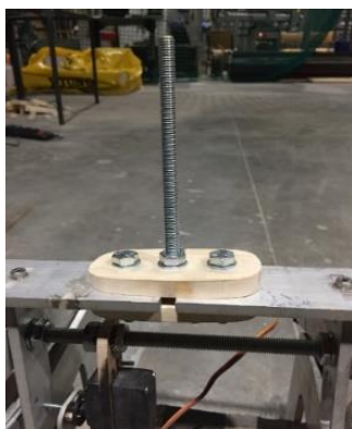
Figure 211 - Lien entre pince de levage et tige filetée d'attache au drone
