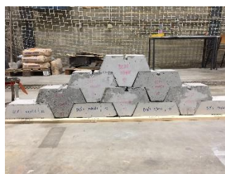
Figure 239 - Configuration des essais avec GGS-T et exemples de murs obtenus
