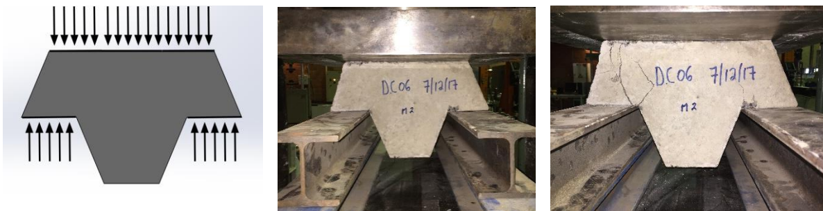
Figures 273 - Cas 6: Schéma du cas expérimenté, dispositif d'essai et DEPT avec fissuration avant rupture
