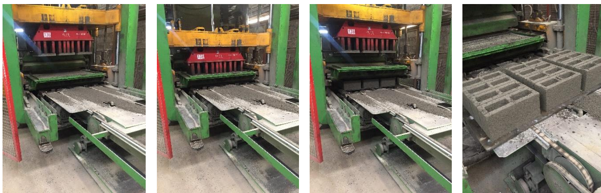
Figures 36 – Etapes du procédé par presse et vibration
