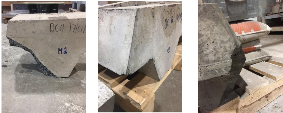
Figures 12 - Fragilité des arêtes fines et des faces inclinées
