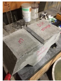
Figures 188 - Etapes de démoulage de l'élément additionnel
