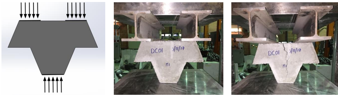
Figures 268 - Cas 1: Schéma du cas expérimenté, dispositif d'essai et DEPT avec fissuration avant rupture
