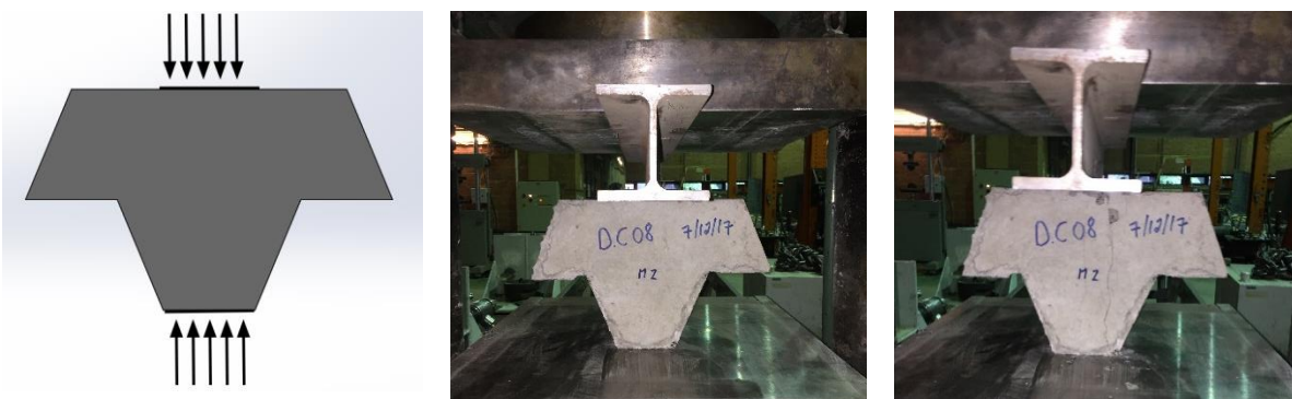
Figures 270 – Cas 3 : Schéma du cas expérimenté, dispositif d'essai et DEPT avec fissuration avant rupture
