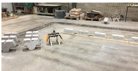
Figure 239 - Configuration des essais avec GGS-T et exemples de murs obtenus
