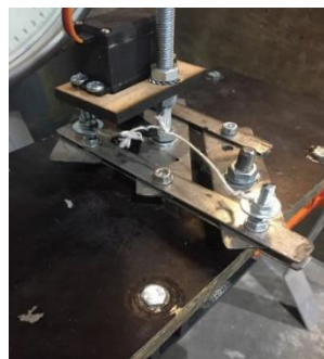
Figures 220 - Transmission de la rotation par fils
