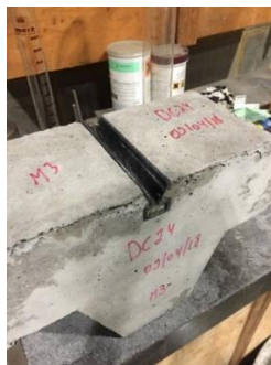
Figures 188 - Etapes de démoulage de l'élément additionnel
