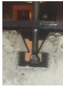
Figures 233 - Diminution de l'épaisseur de la tige
