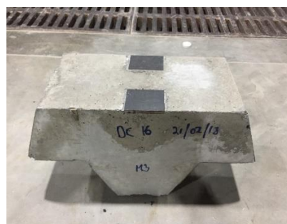
Figure 180 - DEPT équipé de plaquettes métalliques
