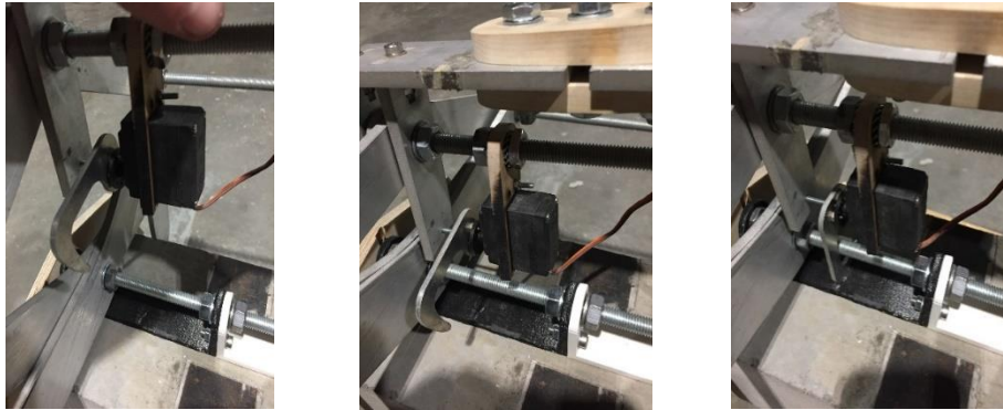
Figures 206 - Rotation du crochet de fermeture du système
