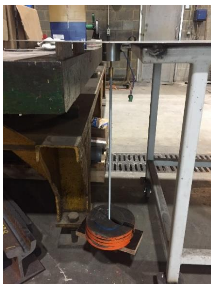
Figure 181 - Dispositif de l'essai de chargement d'un électro-aimant
