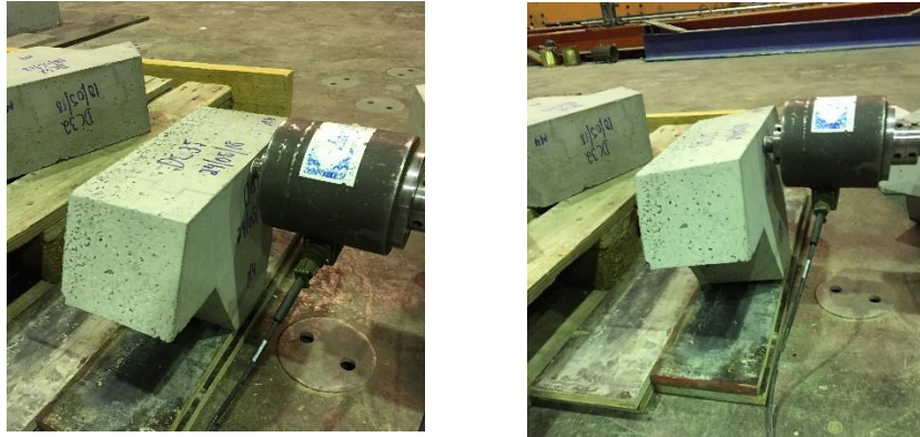
Figures 281 - Essai de basculement latéral sur un DEPT simple
