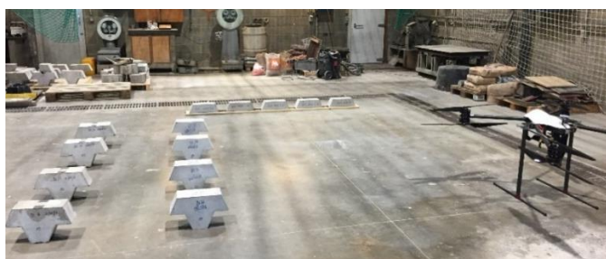
Figures 251 - Installation d'essai: base d'essai, DEPT utilisés et drone avec GGS-G
