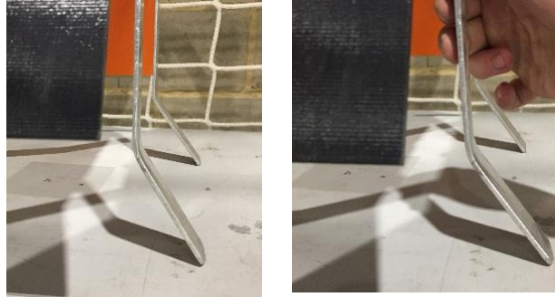
Figure 148 - Déformation des rails de guidage sous force latérale
