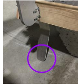
Figure 228 - Contact avec le sol lors de la fermeture de la pince
