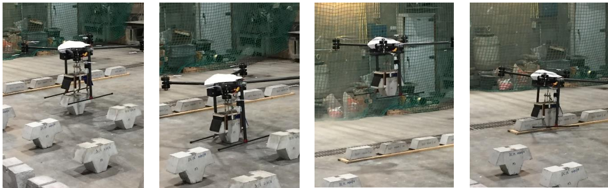
Figures 246 - Photos d'essai: phase de préhension, transport et pose d'élément
