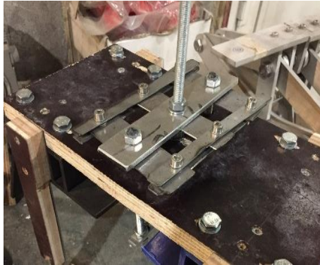
Figure 218 - Dispositif de mise en rotation des tiges T
