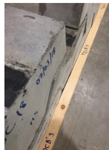
Figure 170 - Cas épaisseur trop faible
