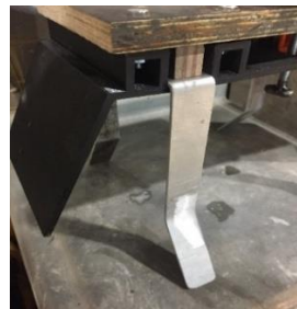
Figures 223 - Eléments de guidage longitudinal de GGS-T modélisés sur SolidWorks et imprimés en 3D
