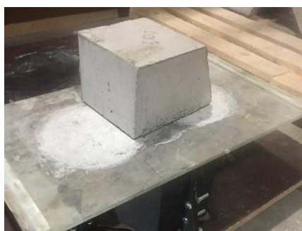
Figure 176 - Mise en place d'une plaque en verre sur la face supérieure du moule 4
