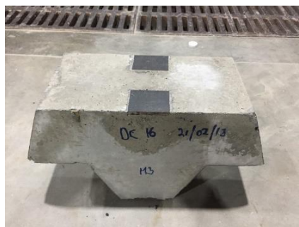
Figure 196 - Placement des plaquettes métalliques dans le DEPT
