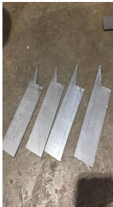
Figures 190 - Fabrication du moule pour DEPT à inclusions latérales
