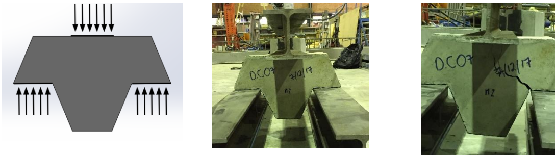
Figures 271 - Cas 4: Schéma du cas expérimenté, dispositif d'essai et DEPT avec fissuration avant rupture
