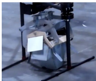
Figures 248 - Tangage observé lors de l'essai du 28 juin 2018
