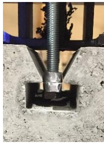
Figures 233 - Diminution de l'épaisseur de la tige
