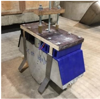
Figure 200 - Ajout des rails de guidage latéral
