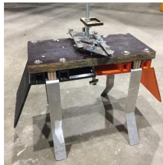
Figure 230 - GGS-T utilisé lors des essais manuels de préhension
