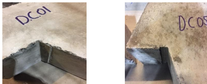
Figures 167 - Transfert du défaut de non-planéité
