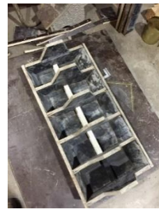
Figures 187 - Intégration de la pièce additionnelle du moule adapté au GGS-T
