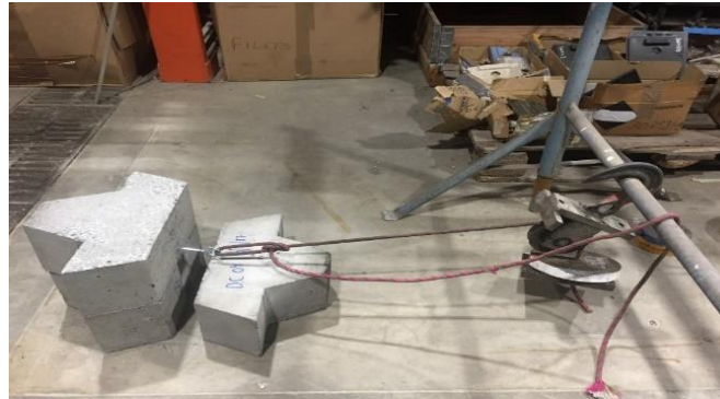
Figure 72 - Essai de détermination du coefficient de frottement
