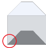
Figure 21 - Angle d'épaisseur nulle
