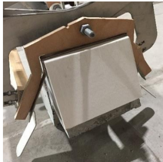
Figure 229 - Rails de guidage latéral de pose en préhension modifiés
