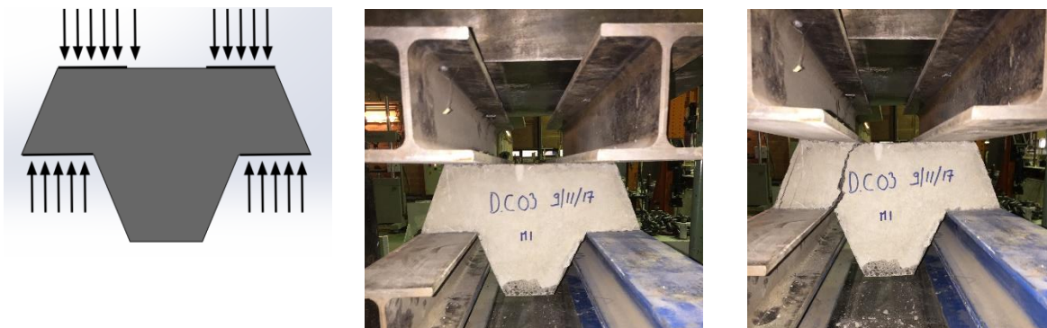
Figures 269 - Cas 2: Schéma du cas expérimenté, dispositif d'essai et DEPT avec fissuration avant rupture
