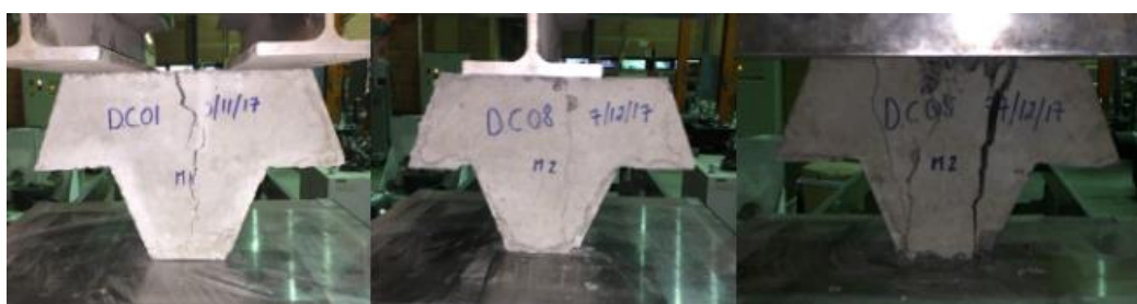
Figures 275 - Fissuration verticale des éléments avec reprise de charge à la base
