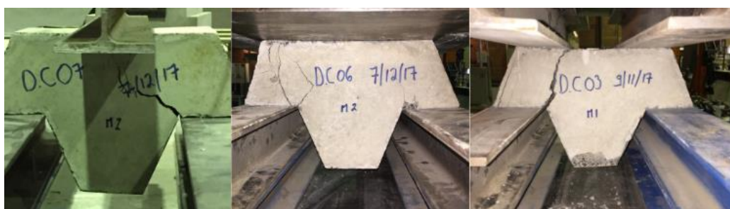
Figures 274 - Fissuration au niveau de l'angle avec différentes inclinaisons selon le type de chargement
