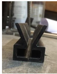
Figures 187 - Intégration de la pièce additionnelle du moule adapté au GGS-T
