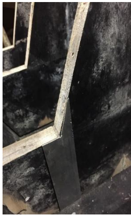
Figures 190 - Fabrication du moule pour DEPT à inclusions latérales
