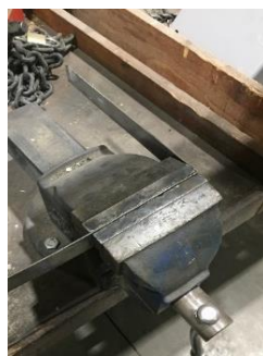
Figure 199 - Pliage des rails de guidage latéral
